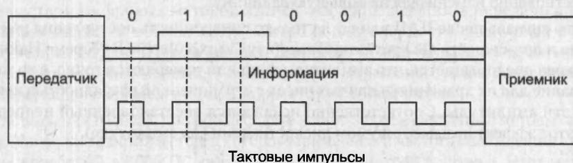
Рис. 9.6. Синхронизация приемника и передатчика на небольших расстояниях
