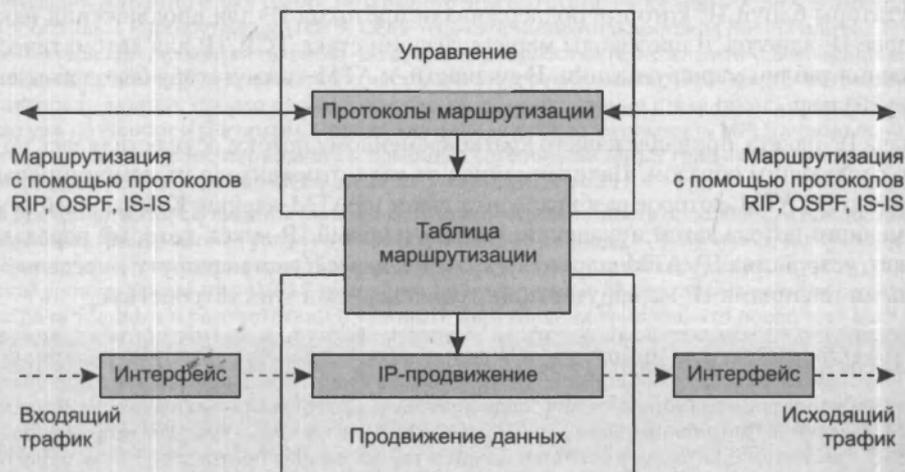
Рис. 20.1. Архитектура IP-маршрутизатора
