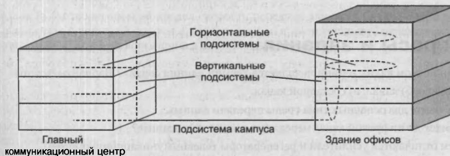
Рис. 8.19. Структура кабельных подсистем
