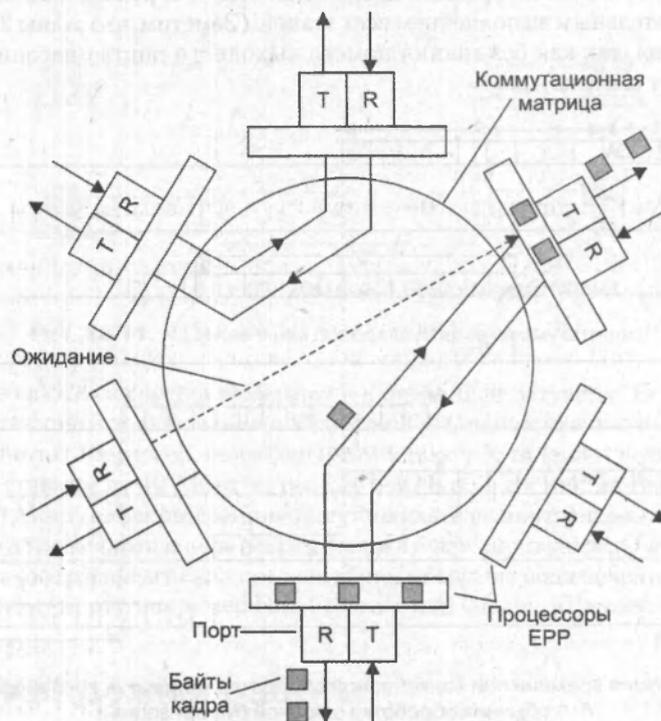
Рис. 13.9. Передача кадра через коммутационную матрицу
