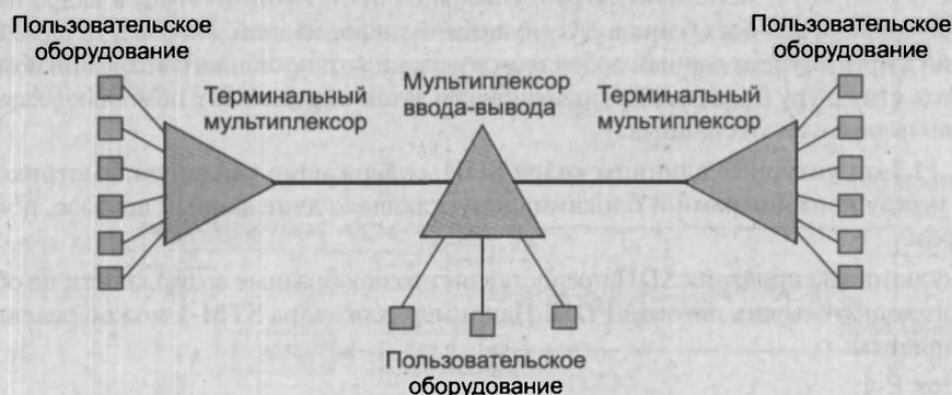
Рис. 11.5. Типы мультиплексоров SDH
