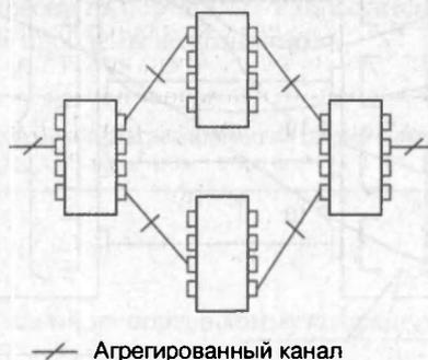
Рис. 14.8. Распределенное агрегирование каналов
