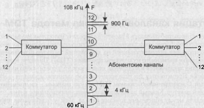
Рис. 9.10. FDM-коммутация
