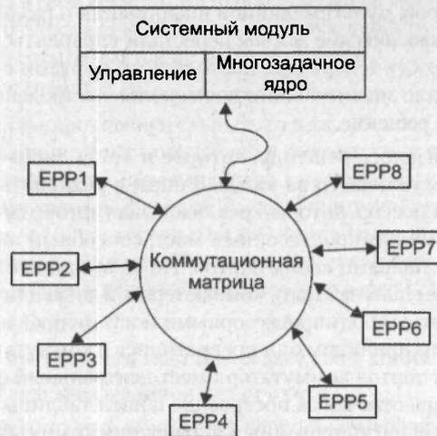
Рис. 13.8. Структура коммутатора EtherSwitch компании Kalpana
