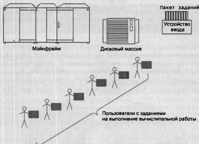
Рис. 1.2. Централизованная система на базе мэйнфрейма
