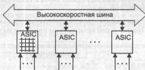
Рис. 13.27. Комбинирование архитектур коммутационной матрицы и общей шины
