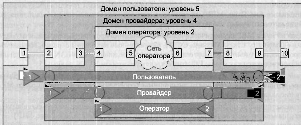
Рис. 21.9. Многодоменное применение протокола CFM
