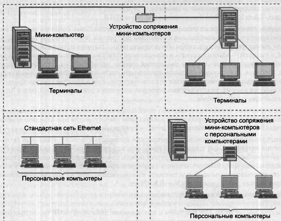
Рис. 1.5. Различные типы связей в первых локальных сетях
