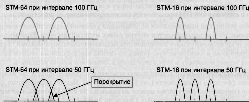
Рис. 11.14. Перекрытие спектра соседних волн для разных частотных планов и скоростей передачи данных
