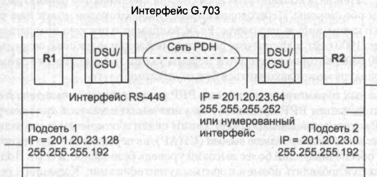
Рис. 19.15. Соединение IP-сетей с помощью выделенной линии
