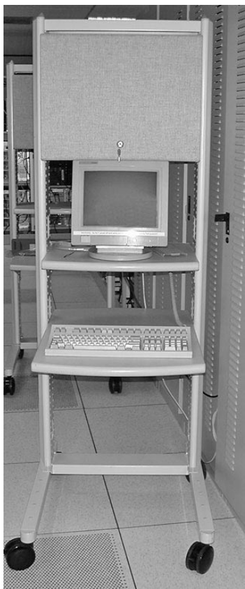
Рис. 6.15. В Synopsys предусмотрено несколько тележек с последовательными консолями, которые можно подвезти к машине при отказе основного консольного сервера или необходимости использовать дополнительные монитор и клавиатуру
