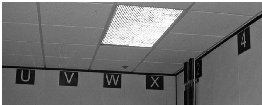
Рис. 6.8. Нумерация на верхней части стен в вычислительном центре в компании Synopsys, которая используется для идентификации стоек и упрощает их поиск
