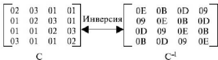
Рис. 9.12. Матрица констант, используемая MixColumns и InvMixColumns
