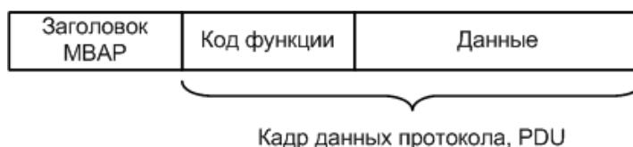
б) Формат Modbus-сообщения для передачи данных по TCP/IP
