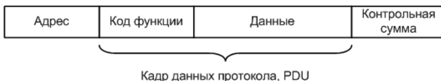
а) Формат сообщения Modbus-RTU для сети на базе RS-422/485
