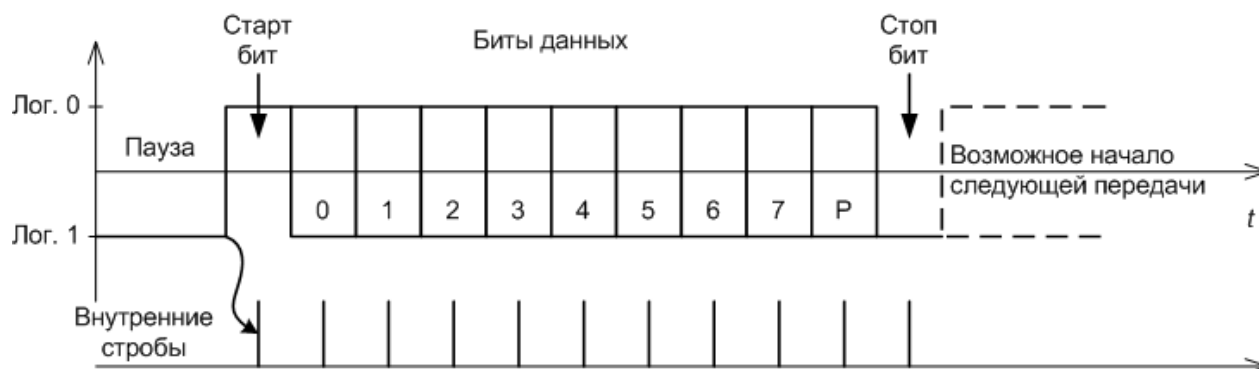
Рис. 3.10. Формат асинхронной передачи
