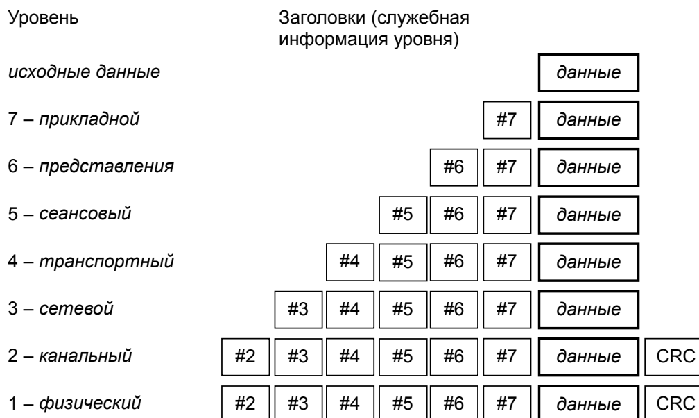
Рис. 3.4. Общая схема передачи информации между уровнями
