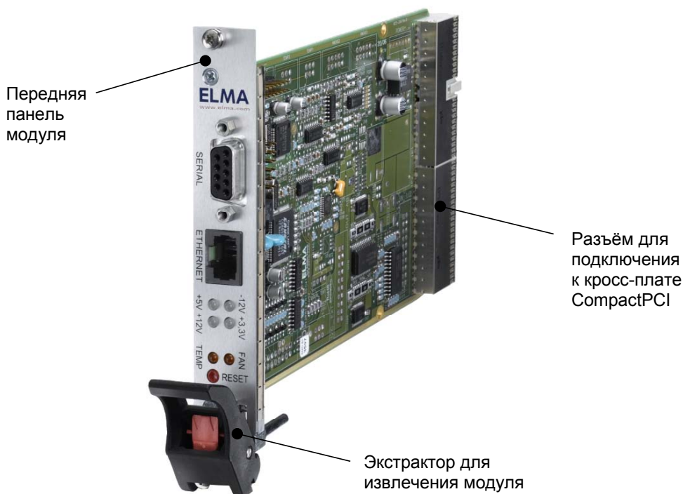
Рис. 2.5. Модуль сетевого адаптера для установки в субблок высотой 3U
