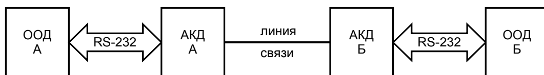
Рис. 3.12. Полная схема соединения по RS-232
