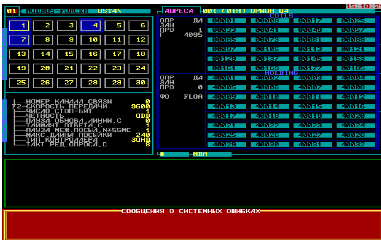
Рис. 7-7 Панель инженера Modbus-Forcer
