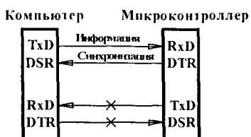
Рис. 6.1. Структурная схема передачи информации из компьютера в микроконтроллер
