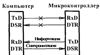
Рис. 6.2. Структурная схема передачи информации из микроконтроллера в компьютер
