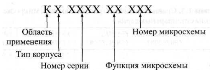
Рис. 1.18. Обозначения отечественных микросхем
