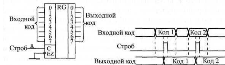
Рис. 4.29. Использование регистра-зашелки для замены регистра, срабатывающего по фронту
