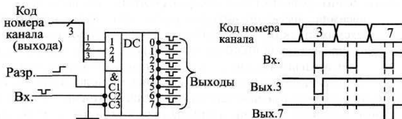
Рис. 3.5. Включение дешифратора как демультиплексора
