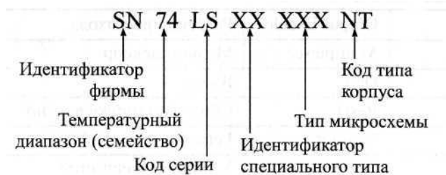
Рис. 1.17. Система обозначений фирмы Texas Instruments
