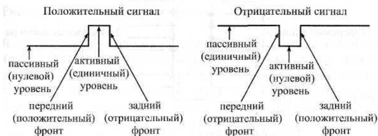
Рис. 1.13. Элементы цифрового сигнала
