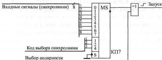
Рис. 8.15. Схема запуска логического анализатора
