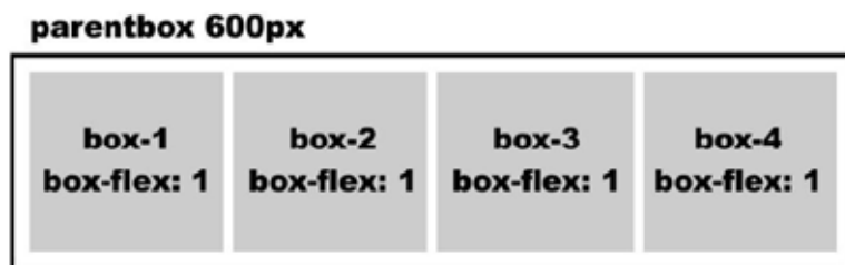
Рис. 2.11. Пространство поровну делится между блоками
